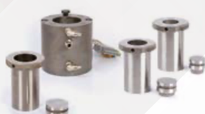
Corps de chauffe pour moules d'enrobage de Ø 25,4 (1"), 30, 40, 1"1/4, 1"1/2, 50 et 2".
