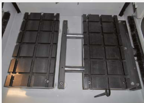
Tavola trasversale dell'asse X, corsa 120 mm
