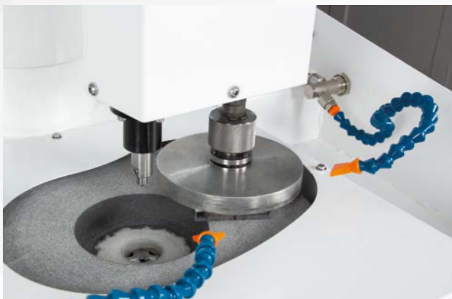
Prelucidatura di campioni grezzi di grandi dimensioni.
