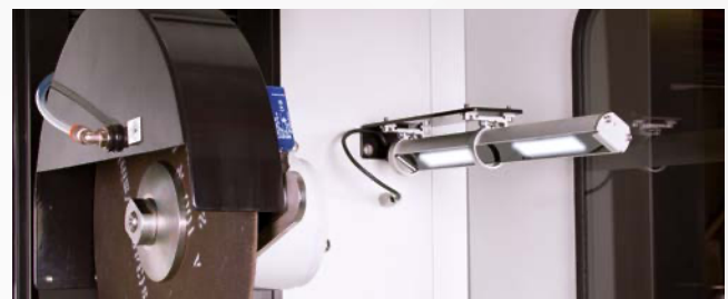
Potente illuminazione a LED dell'area di taglio
