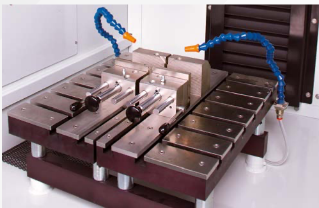
Camera di taglio spaziosa: L 408 x 422 mm, con aperture su entrambi i lati destro e sinistro
