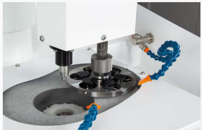
Prelucidatura di campioni rivestiti, montati su un porta campioni a pressione centrale.
