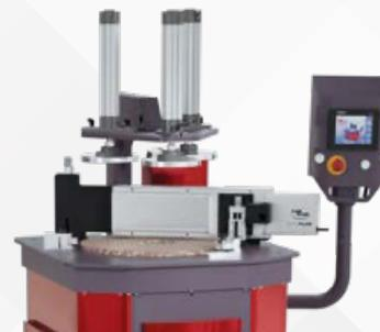
Das System AUTOPLAN ermöglicht eine effiziente Verwaltung der Ebenheit und der Nuten der Läppscheibe, die dank der in die Maschine integrierten Befestigungspunkte in wenigen Minuten positioniert und demontiert werden kann.
